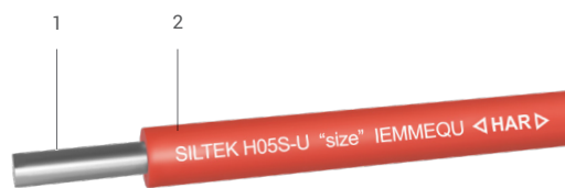
1*.Rame rigido Classe 1 CEI EN 60228 | Solid copper Class 1 CEI EN 60228 2.Gomma siliconica EI2 | Silicone rubber EI2
