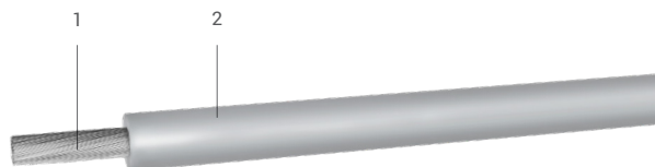
1. Rame flessibile Classe 5 EN 60228 | Flexible copper Class 5 CEI EN 60228 2. Tecnopolimero irraggiato antifiamma | Flame retardant irradiated technopolymer
