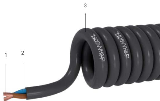
1. Rame flessibile Classe 6 CEI EN 60228 | Flexible copper Class 6 CEI EN 60228 2. PVC T12 | PVC T12 • 3. PVC TM2 | PVC TM2
