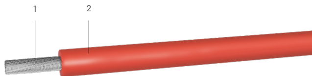
1. Rame flessibile Classe 5 CEI EN 60228 | Flexible copper Class 5 CEI EN 60228 2. Gomma siliconica | Silicone rubber
