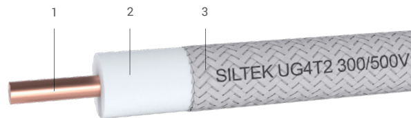
1. Rame rigido Classe 1 CEI EN 60228 | Solid copper Class 1 CEI EN 60228 2. Gomma siliconica EI2 | Silicone rubber EI2 • 3. Treccia in fibra di vetro | Fiberglass braid
