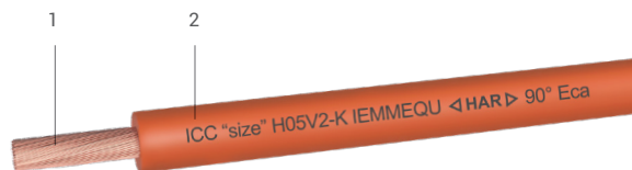
1. Rame flessibile Classe 5 CEI EN 60228 | Flexible copper Class 5 CEI EN 60228 2. PVC TI3 | PVC TI3
