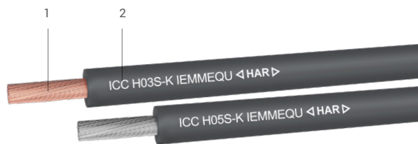
1. Rame flessibile Classe 5 CEI EN 60228 | Flexible copper Class 5 CEI EN 60228 2. Gomma siliconica EI2 | Silicone rubber EI2
